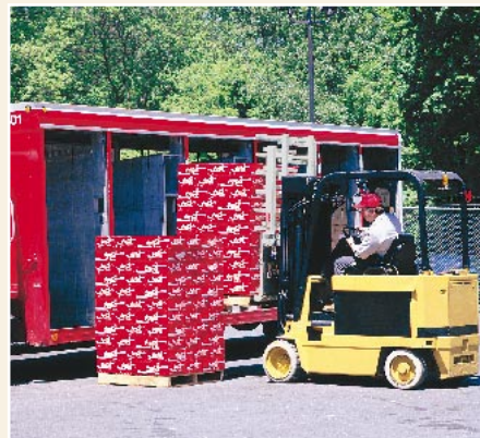
La fonction déplacement latéral permet un positionnement très précis des charges pour les opérations critiques.
