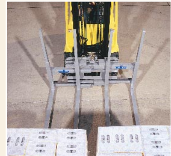
Utilisez la fonction déplacement latéral pour aligner rapidement les fourches.
