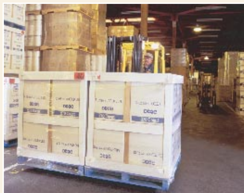
Accolez des charges entre elles pour une meilleure stabilité durant le transport.
