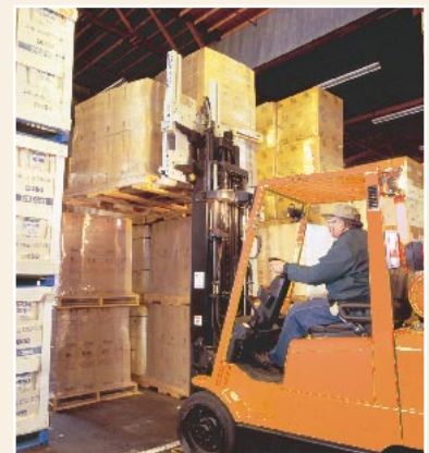
Le bâti étroit permet la même manœuvrabilité qu'avec un chariot pour charge simple.
